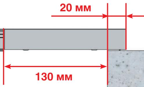
Рис. 7.13. Установка встык к проему
